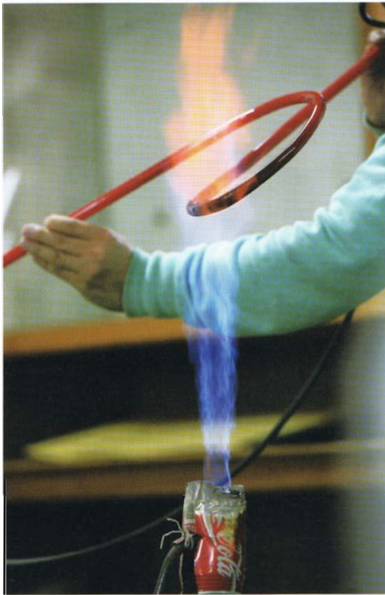
ネオンサインも炎によって自在に加工。ガラス細工はホットワークとコールドワークに大別されるが、清風さんの技術はホットワーク
